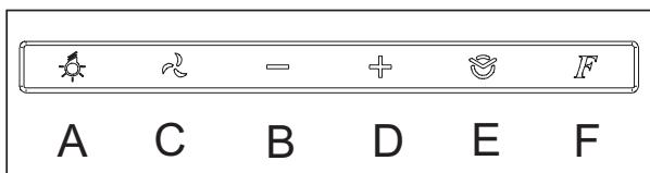
Desde la posición de apagado, al pulsar cualquier tecla el mando se activará en modalidad de „stand-by”; los símbolos serán retroiluminados con una luz blanca, permitiendo al usuario ver y seleccionar la función deseada. A continuación, al presionar cualquiera de las teclas se activará la función correspondiente y se iluminará el símbolo. Tras apagarse todas las funciones, el mando permanecerá en „stand-by” durante unos 30 segundos y después se apagará automáticamente.
