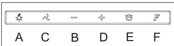
Avec l'appareil éteint, la pression de l'une des touches active la commande en mode veille qui, par rétro-éclairage des symboles en blanc, permet à l'utilisateur de voir et de sélectionner la fonction souhaitée. Une nouvelle pression de l'une des touches active la fonction correspondante en éclairant son symbole. Après avoir éteint toutes les fonctions, la commande reste en veille pendant 30 secondes environ puis s'éteint automatiquement.
