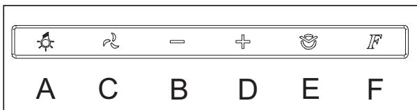
Bei ausgeschaltetem Gerät wird durch Berühren irgendeiner Taste die Steuerung im Standby aktiviert. Die Hintergrundbeleuchtung beleuchtet die Symbole mit einem weißen Licht und der Benutzer kann dann die gewünschte Funktion sehen und auswählen. Drückt man darauf eine der Tasten, wird die entsprechende Funktion aktiviert und deren Symbol beleuchtet. Nach dem Ausschalten aller Funktionen bleibt die Steuerung etwa 30 Sekunden auf Standby und schaltet sich dann automatisch ab.
